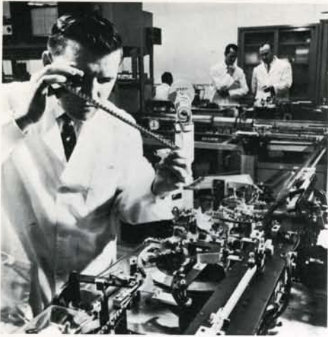
La prima linea di produzione di transistor completamente automatizzata venne progettata dai tecnici IBM a Poughkeepsie, N.Y., e messa in funzione nel 1960.
