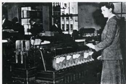
La produzione di macchine a schede perforate aumentò rapidamente negli anni fra le due guerre. Questa selezionatrice venne ampiamente usata fino ai tardi anni '40. Molti impianti a schede sono rimasti in funzione fino agli anni 60.
