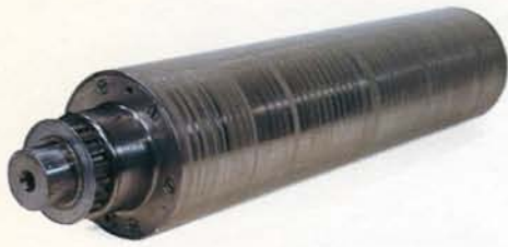
Tamburo magnetico, montato sul calcolatore 650. Ruotava alla velocità di 12.500 giri al minuto e forniva 10.000 caratteri di memoria registrati magneticamente lungo 40 piste.
