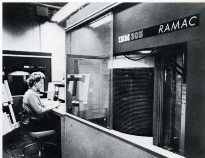
Nel 1957 il RAMAC 305, il primo sistema di memoria a dischi, segnò una svolta decisiva. Queste macchine divennero il principale supporto di memoria per i lavori «on-line». In meno di un secondo, il braccio ad «accesso casuale» del RAMAC individuava i dati registrati in uno qualsiasi dei suoi 50 dischi (a destra, in alto).
