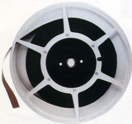
Il Sistema 701 uscito nel 1952, fu uno dei primi elaboratori in cui le informazioni venivano lette, scritte e memorizzate su nastro magnetico. Con una densità di registrazione pari a 100 caratteri per pollice, una bobina di 8 pollici di diametro sostituiva 12.500 schede perforate. Le unità a nastro del 701 montavano parti in plastica piuttosto che in metallo.
