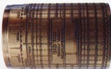
Cilindretto di 8 cm circa montato sulla prima stampatrice per la produzione industriale delle schede: la Carroll, realizzata nel 1924. Questa stampatrice veloce produsse miliardi di schede all'anno.
