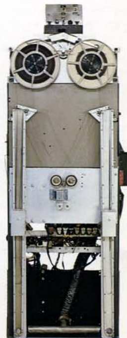
Nel 1957 il RAMAC 305, il primo sistema di memoria a dischi, segnò una svolta decisiva. Queste macchine divennero il principale supporto di memoria per i lavori «on-line». In meno di un secondo, il braccio ad «accesso casuale» del RAMAC individuava i dati registrati in uno qualsiasi dei suoi 50 dischi (a destra, in alto).
