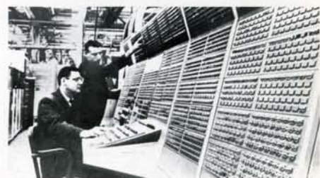
Il SAGE, la più grande macchina a valvole, fu costruita intorno agli anni '50 per la difesa aerea degli Stati Uniti nel quadro di un programma diretto dal Massachusetts Institute of Technology.
