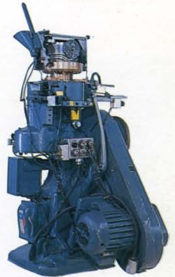
Adattando e modificando opportunamente macchine pastigliatrici — come questa della Colton Manufacturing che produceva 32.000 nuclei di polvere di ferrite compressa all'ora — la IBM riuscì a fabbricare miliardi e miliardi di nuclei negli anni '50 e '60.
