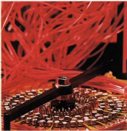
Il controllo automatico di qualità di migliaia di elementi circuitali. L'apparecchio della foto può controllare in meno di un minuto un wafer di silicio composto da oltre 100 chip logici o di memoria contenenti migliaia di transistor.
