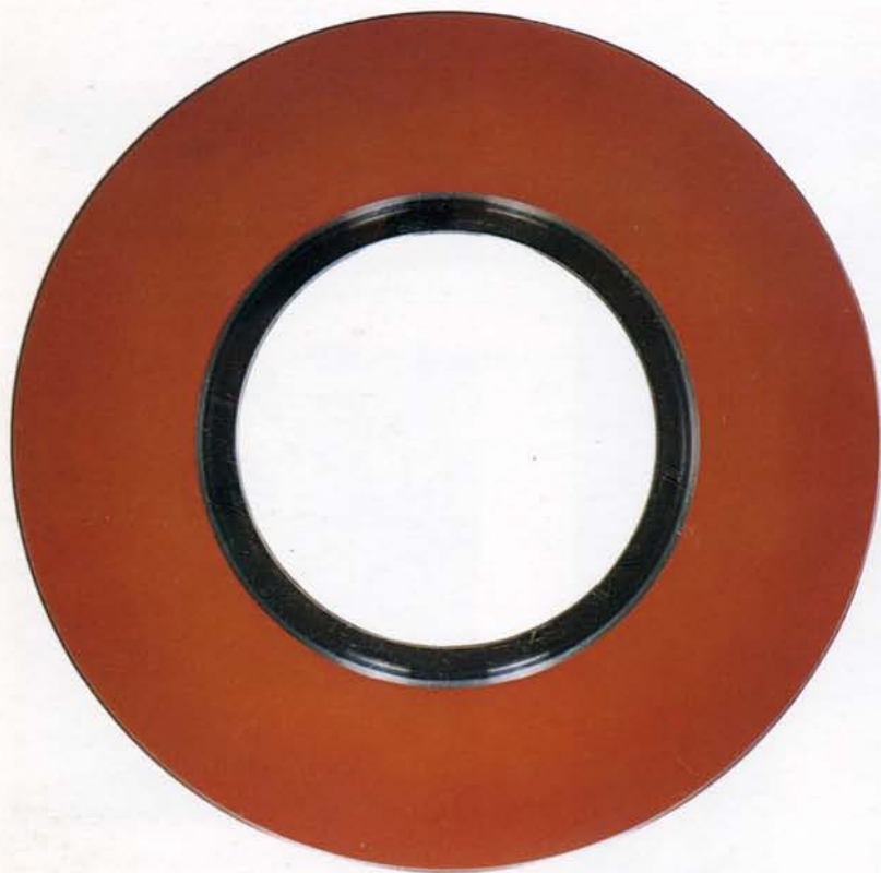
Nel 1957 il RAMAC 305, il primo sistema di memoria a dischi, segnò una svolta decisiva. Queste macchine divennero il principale supporto di memoria per i lavori «on-line». In meno di un secondo, il braccio ad «accesso casuale» del RAMAC individuava i dati registrati in uno qualsiasi dei suoi 50 dischi (a destra, in alto).
