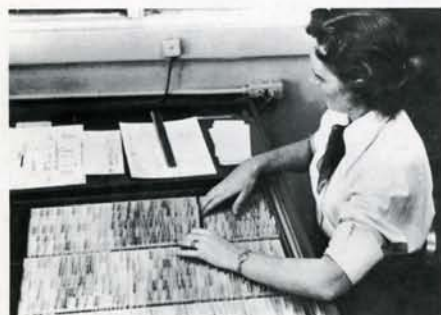
Le schede perforate erano il mezzo base per registrare le informazioni, e sovente venivano organizzate in archivi «preperforati».
