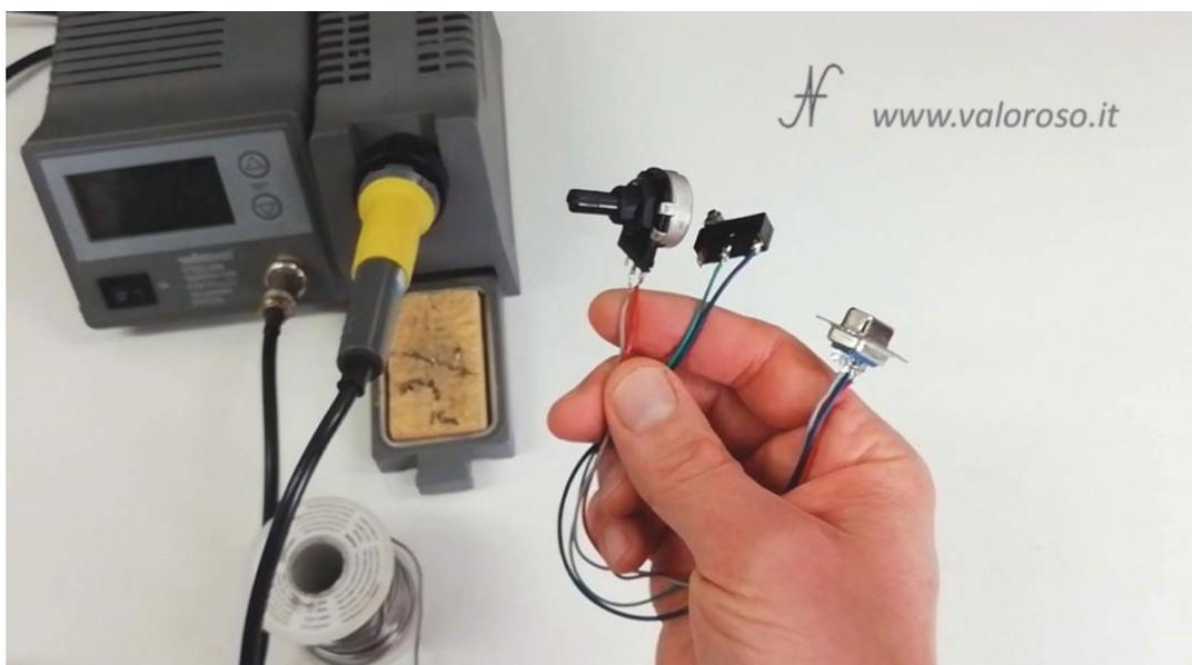
A questo punto si può unire il potenziometro al microswitch del fire. Per farlo, utilizzo un filo di rame, che saldo sul potenziometro e faccio passare nei fori dello switch. Nel video, spiego i dettagli.
